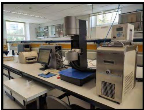
Dispone de un reómetro de control de esfuerzo (Haake RS600) que permite realizar medidas viscoelásticas y de flujo de muy diversos tipos de materiales. También permite realizar análisis del comportamiento termo-reológico de polímeros mediante tests dinámicos a frecuencia constante en barrido de temperatura.
